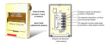
La estación de liberación manual es normalmente un dispositivo de inicio de línea seca normalmente abierto. El 276A-REL es una estación de acción simple que requiere que el usuario hale la manija de liberación para iniciar la liberación de un agente supresor de incendios. El 278A-REL (mostrado) es una estación de doble acción que requiere que el usuario alce la puerta superior, y luego hale la manija de liberación para que esta se inicie.
