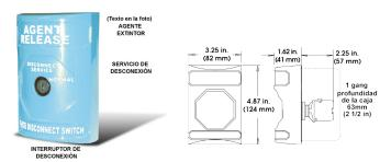
El interruptor de desconexión de servicio se usa para deshabilitar temporalmente el sistema de supresión de fuego. Un interruptor se instala en cada uno de los circuitos de liberación entre SIGA-REL y el relé de fin de línea RELA-EOL. Abrir el interruptor de Desconexión de Servicio permite que el sistema de alarma contraincendios sea probado sin activar el sistema de supresión de fuego. La operación de este interruptor causa una señal de problema en el panel de control.
