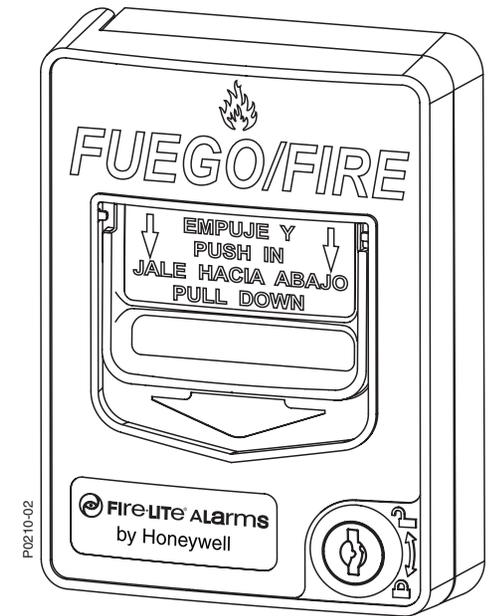
**¡ADVERTENCIA!** No desmontar la tapa de la estación manual durante su instalación, ya que no se podrá volver a instalar a la placa de montaje después de que la misma se haya fijado a una caja de conexiones.
